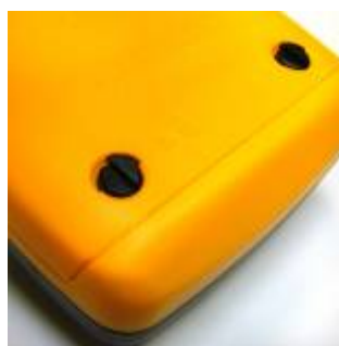
Крепёж крышки батарейного отсека
