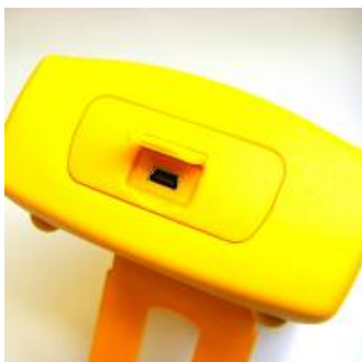
Разъём для подключения адаптера (конвертор для опционального внешнего модуля давления)
